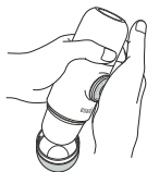
При первых 8 нажатиях создается давление. Накачивайте медленно, пока не выйдет весь кофе.
